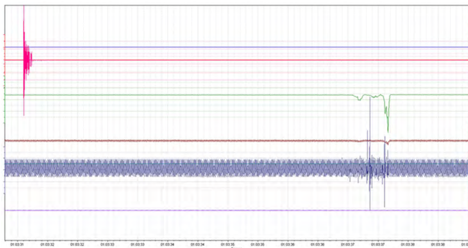
Рис.3. Снимок с экрана электронного самописца: красный цвет – канал микрофона;зеленый цвет – измеритель тока короны; синий цвет – канал радиоприемника «Волна-К», 100 кГц
