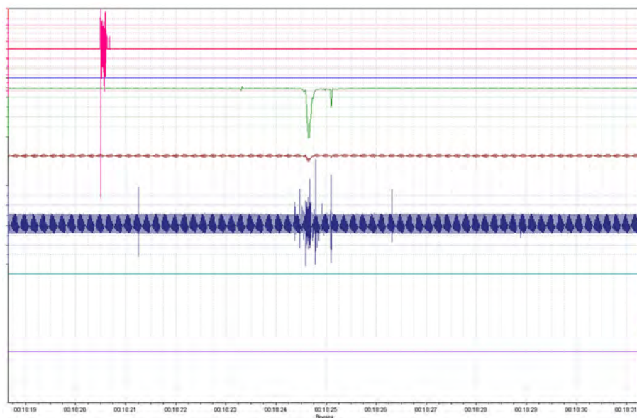
Рис.2. Снимок с экрана электронного самописца: красный цвет – канал микрофона; зеленый цвет – измеритель тока короны; синий цвет – канал радиоприемника «Волна-К», 100 кГц
