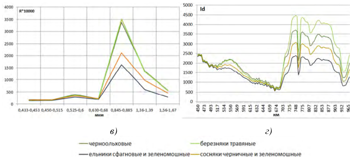
Рис. 1. Спектральные характеристики различных типов леса, полученные по результатам измерений многоспектральной аппаратурой КА Landsat 8 (а–в) и гиперспектральной аппаратурой КА Ресурс-П (г) в третий (а), четвертый (в, г) и седьмой (б) фенологические периоды (окончание)
