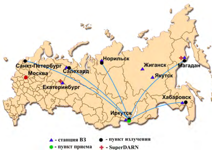
Рис. 1. Трассы НЗ для Ионозонда-МС, расположенного в п. Торы (Бурятия)
